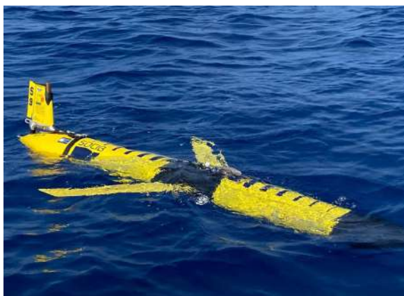
Imagen 6. Glider sloop_09 durante el inicio de la misión FRIPP. Autoría: ICTS SOCIB.
